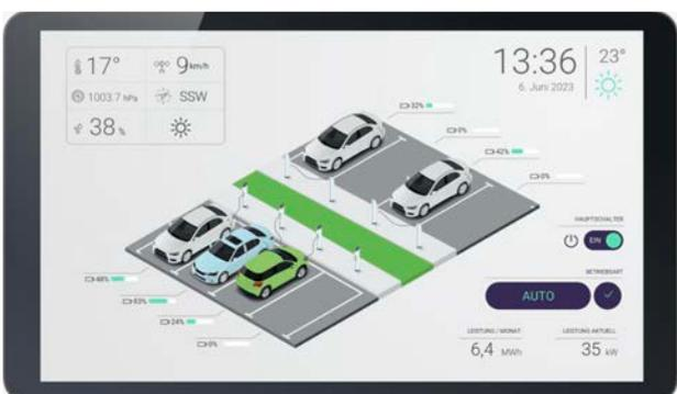
Die verfügbare Energie wird durch unser Lastmanagement intelligent verteilt, so dass die verfügbare Anschlussleistung nicht überschritten wird. Wir sorgen dafür, dass Lastspitzen reduziert werden und die Energie gleichmäßig verteilt wird. Die Priorisierung von einzelnen oder mehreren Ladepunkten kann auf Wunsch individuell eingestellt werden.
